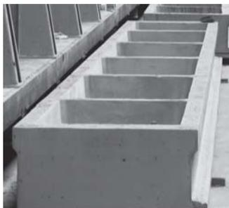
Завод «Обербетон» виготовляє залізобетонні складки трибун різної форми (в залежності від вимог проекту), які використовуються при будівництві або реконструкції об'єктів спортивного призначення.
