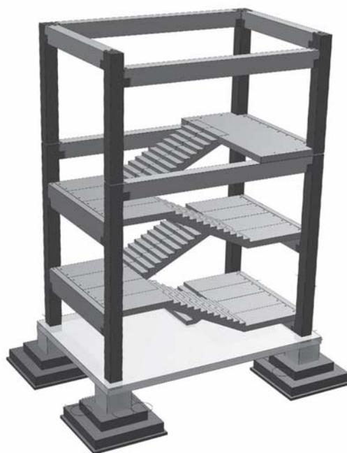
Під кожний сходовий марш без майданчика можливе виготовлення сходових майданчиків з індивідуальними геометричними розмірами залежно від проекту. Крім цього, можлива установка додаткових закладних деталей, наприклад, для обладнання стійок перильних огорожень.
