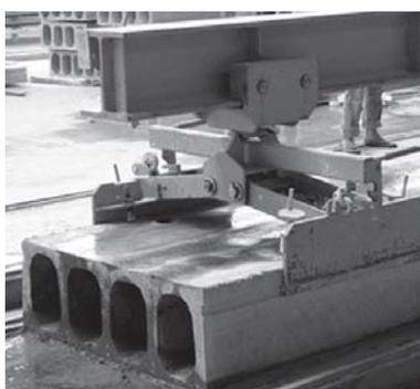
Пустотні плити піднімаються за допомогою спеціальних захватів, підвішених до сталевій піднімальній балки-траверси. У деяких випадках допускається застосування монтажних ременів (м'яких строп).
